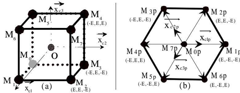
**Figure 2.** Caractérisation de l'onduleur de tension triphasé deux niveaux
